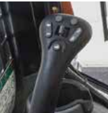
SJC (Selectable Joystick Controls, comandi a joystick selezionabili)
